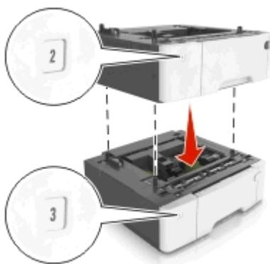
**4** 将打印机与 650 页双层进纸匣对齐，然后将打印机向下放到位。
